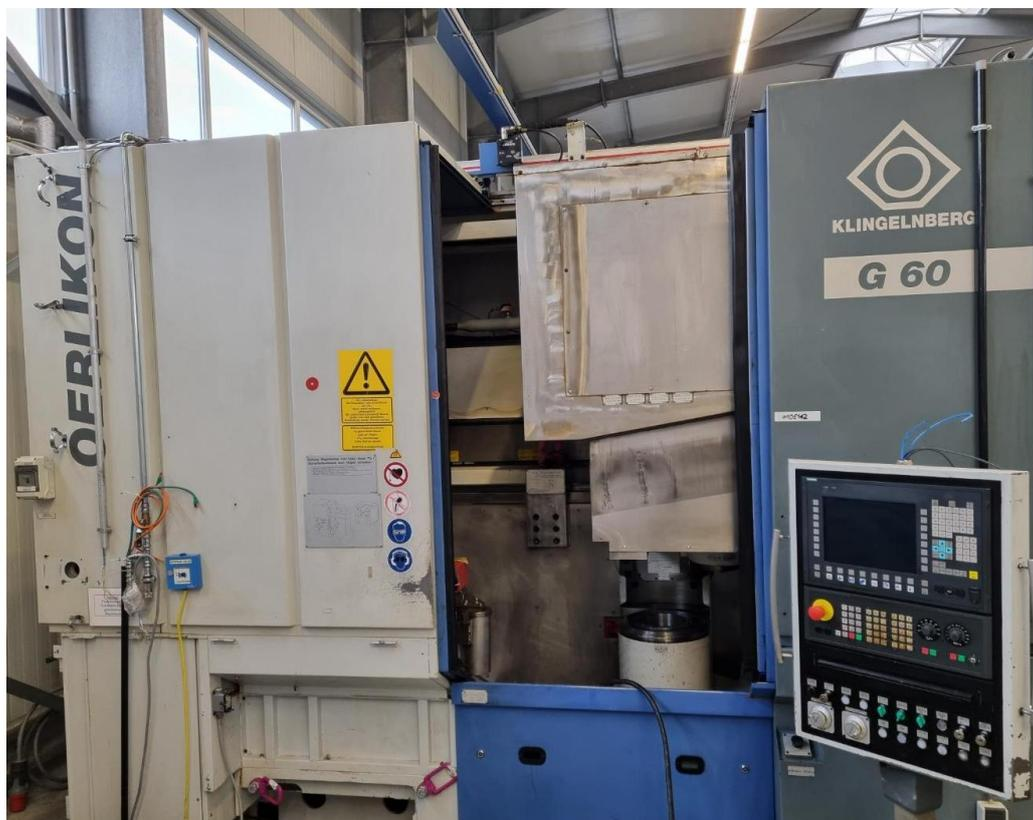
Die OERLIKON G60 ist eine Präzisionsschleifmaschine zur hochgenauen Fertigbearbeitung von spiralverzahnten Kegelrädern bis 600mm Tellerraddurchmesser nach den bekannten Systemen KLINGELNBERG, WIENER, OERLIKON und GLEASON sowie zur Bearbeitung von Stirnkupplungen und CURVIC-COUPLINGS®.
